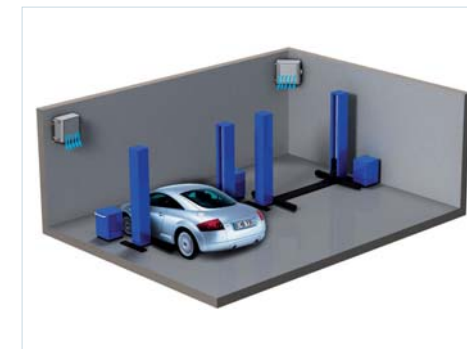
Einsatzbeispiel der Luftkühlanlage AOW in einer Servicestation
